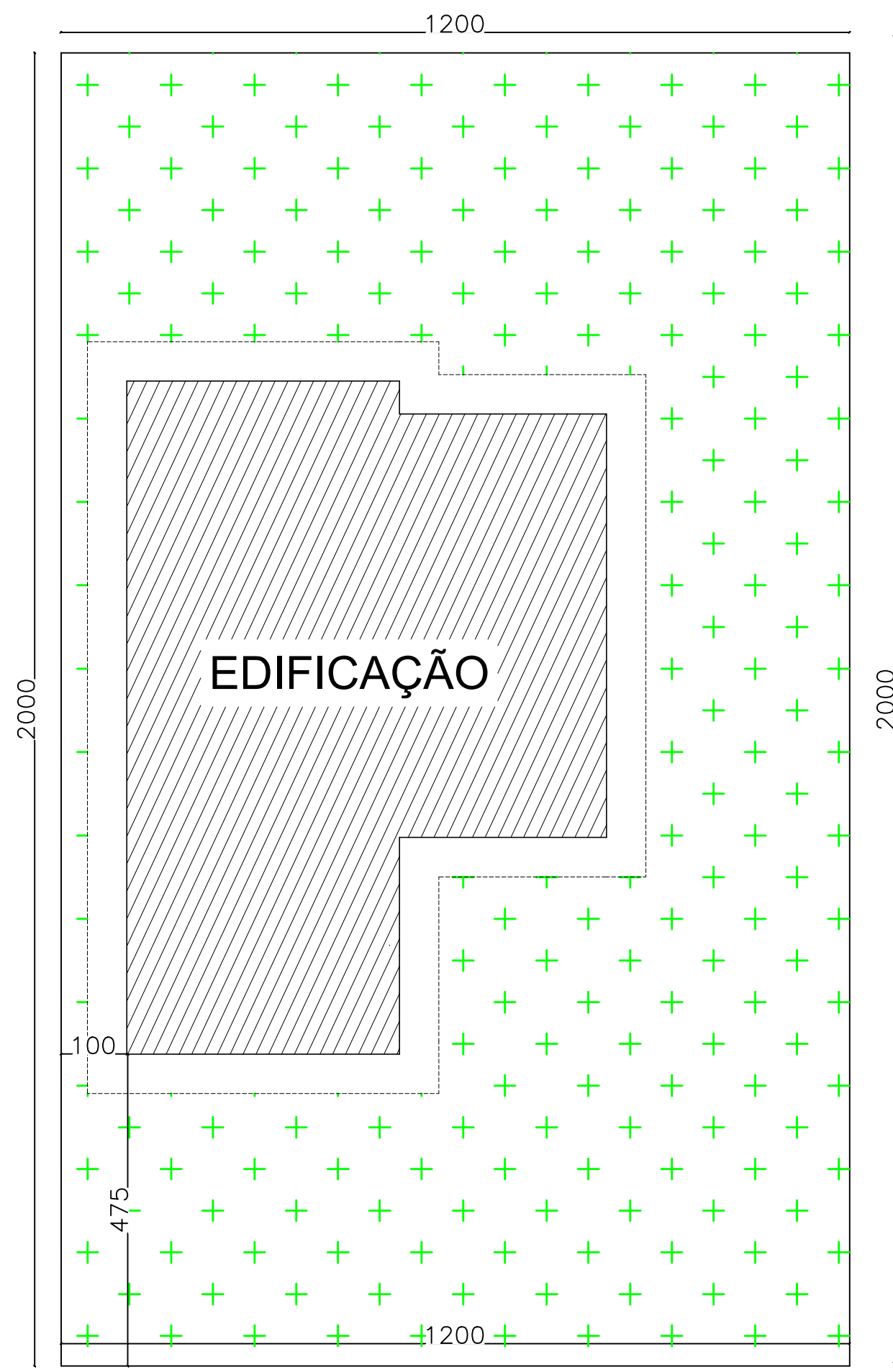
PLANTA DE IMPLANTAÇÃO ESCALA 1:50 ÁREA DO TERRENO: 240,00 M² ÁREA DA EDIFICAÇÃO: 62,83 M² ÁREA PERMEÁVEL: 177,17 M²
