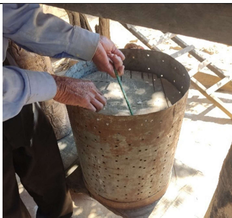
Figura 6: Tambor metálico perfurado adaptado para auxiliar na mandioca ralada . Alex Alves Pereira, 03 nov. 2025.
