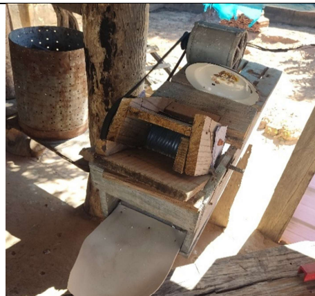
Figura 5: Ralador e cilindro artesanal construído em madeira e metal, empregado no processo de ralação das mandiocas. Alex Alves Pereira, 03 nov. 2025.
