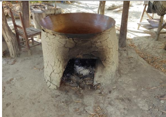
Foto 4: parte frontal do fogareiro, onde é colocada a lenha para torra da farinha. Alex Alves, 18 jul. 2024.
